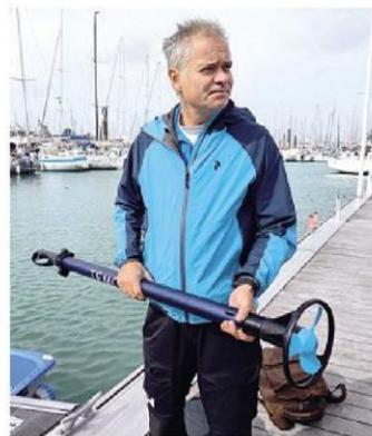
*Le tube télescopique mesure de 130 à 170 centimètres, et il pèse moins de 5 kilos !*
